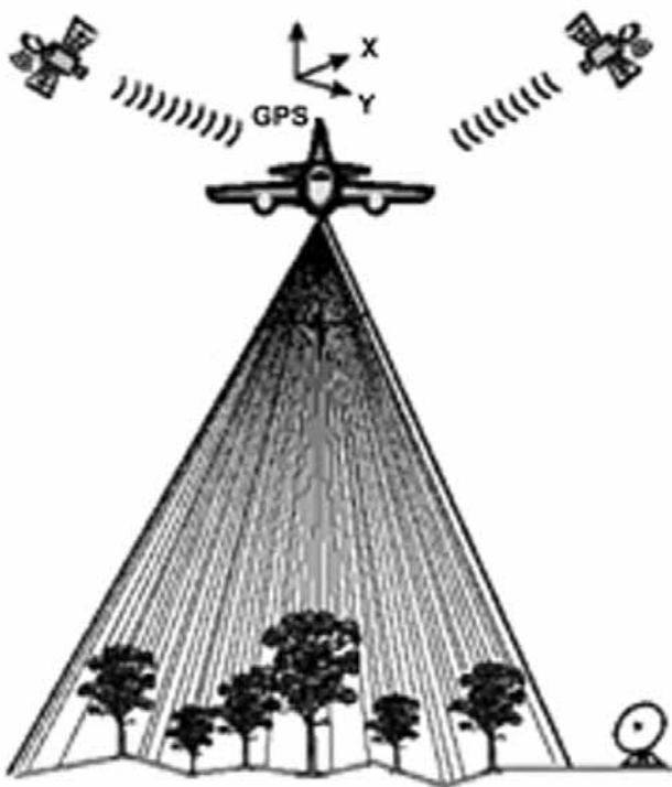
Laserkeilain lähettää laserpulsseja. Takaisin vastaanottiin heijastuvat kohteiden korkeushavainnot, jotka kuvastavat puuston ja maanpinnan korkeutta. Laserkeilaus tehdään n. 2 km korkeudesta. Laserkeilaus alueet ovat 50 000 – 100 00 ha.
