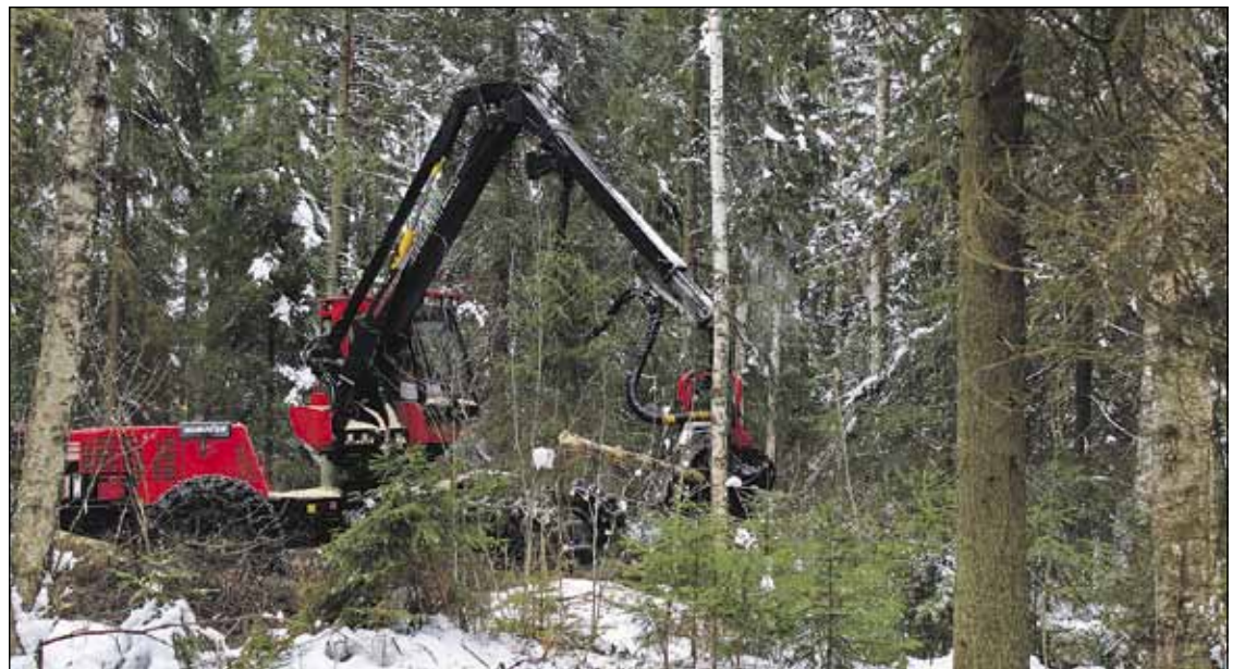
Järeä hakkuukone mahdollistaa isompien puiden hallitun kaadon taimiaineksen tuhoutumista välttämällä.
