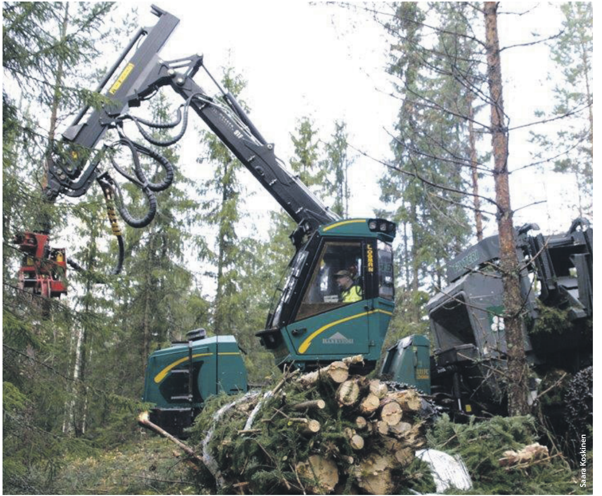
Fixteri-paaleja on helppo käsitellä. Haketus voidaan tehdä vasta raaka-aineen käyttöpaikalla tai terminaalissa.
